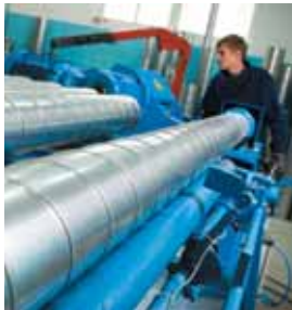
Spiro Ducts Workshop Цех изготовления спирально-навивных воздуховодов
