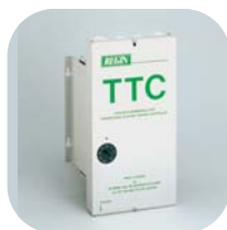
TTC-2000 Регулятор температу- ры для электрических воздухонагревателей. Макс. нагрузка: 16500Вт, 400В, 3фазы
